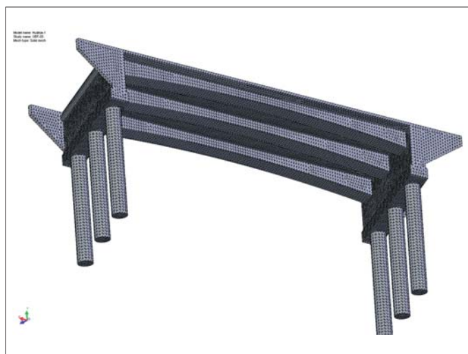
Slika 15 • Slika modela mosta čez Hudinjo v Celju po mreženju v programu CosmosWorks
