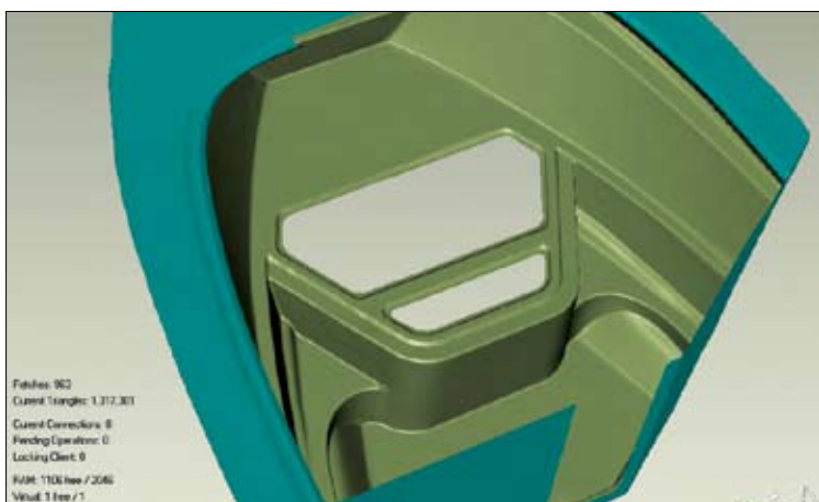
Urejanje skenirane datoteke poteka v programski opremi Geomagic. Model CAD v datotečnem formatu IGES (17 MB).
