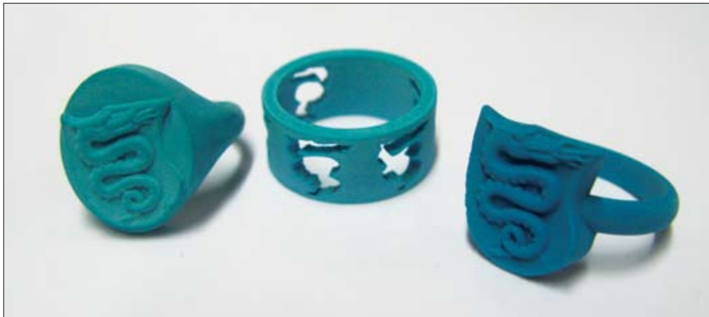
S 3D-tiskalnikom Solidscape natisnjeni voščeni konceptni modeli prstana z motivom zmaja. Modeli se lahko uporabijo kot pozitivni za ulivanje zlata ali le za preverjanje oblike in velikosti.
