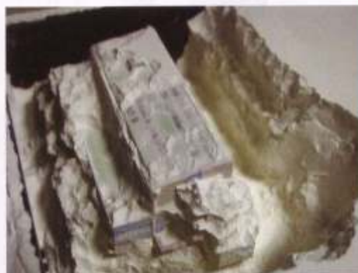
◀ Grob izkop objekta iz prahu. Pri tem je treba biti previden, saj je izdelek še dokaj krhek.
