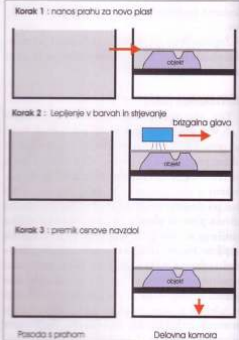
Z lepilom lepimo material v obliki prahu.
