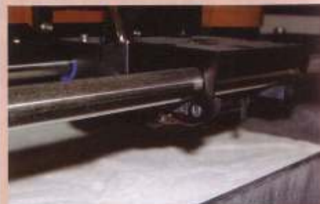
Priprava na izdelavo objekta. Vodilo za nanos prahu pogladi plast prahu v komori za izdelavo objekta, glave se očistijo.
