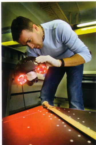
Kristjan Celec skenira 3200 let star bronast meč, ki so ga našli v Blejskem jezeru pri Mlinem. Pri tem uporablja samopozicionirni laserski skener; z njim bo podatke vnesel v posebno napravo, ki bo – podobno kot računalniški tiskalnik natisne skenirano besedilo – izdelala natančno plastično kopijo meča.
