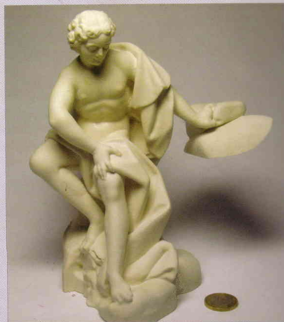
Na 3D-tiskalniku izdelana pomanjšana kopija detajla Narcisovega vodnjaka kiparja Robbe, ki stoji v Mestni hiši v Ljubljani. Kip Narcisa je bil predhodno skeniran s 3D-skenerjem.
