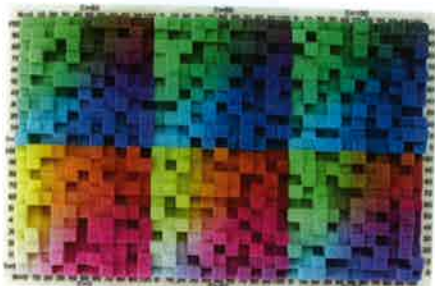
Slika 3: 24-bitni barvni izpis omogoča barvno polno izdelavo modelov in s tem učinkovito vizualizacijo ter predstavitev idej.
